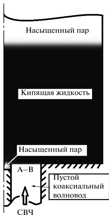
Рис. 1. Область расчета и распределение жидкой и паровой фаз n -гептана в начальный момент. Г-образный участок А–В пронизаем для СВЧ-волны и не пронизаем для n -гептана.
